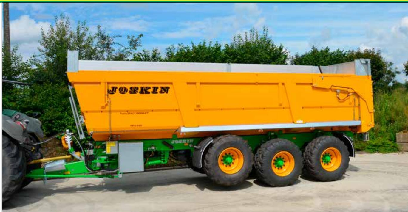
Joskin предлагает для прицепов-самосвалов моделей Trans-SPACE 7000/125 и 8000/150 практичные регулируемые гидравлические надставные борта. Они позволяют снизить высоту загрузки и увеличить объем кузова. Дополнительный объем для модели 7000/125 составляет 8,4 м<sup>3</sup>, а на модели 8000/150 - 9,4 м<sup>3</sup>.
